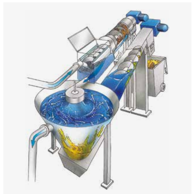
Prinzipische Skizze der HUBER Coanda Kompaktanlage ROTAMAT® Ro5 C.
