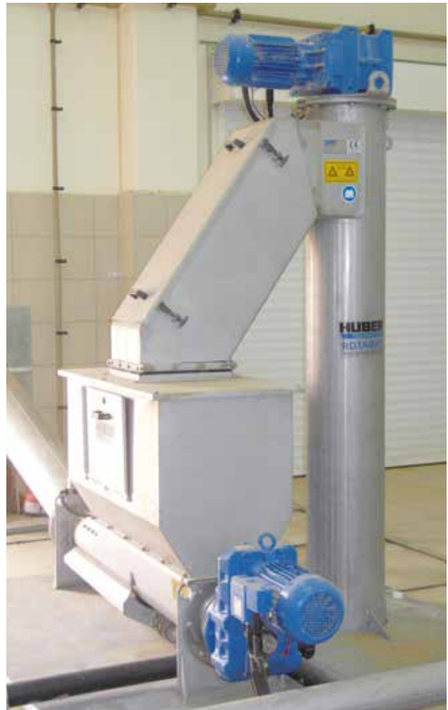
Eine HUBER Transportschnecke Ro8 wirft als Senkrechtförderer Rechengut in eine HUBER Waschpresse WAP®.
