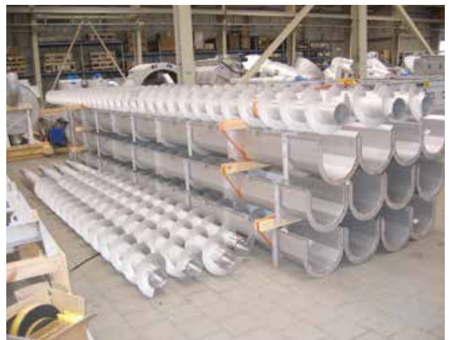
Fertigung der HUBER Transportschnecken Ro8 und Ro8 T im Werk in Berching.
